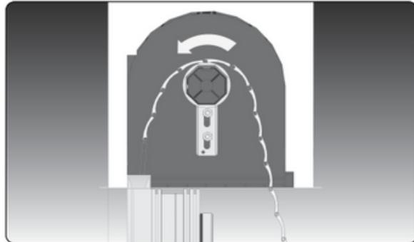
29. Führen Sie den Mantel durch das Wickelrohr, unterer Streifen mit der Dichtung nach unten, wie in der Abbildung oben gezeigt. Sichern Sie vor dem Aufschieben der Armierung das Wickelrohr, um Profilschäden zu vermeiden.
