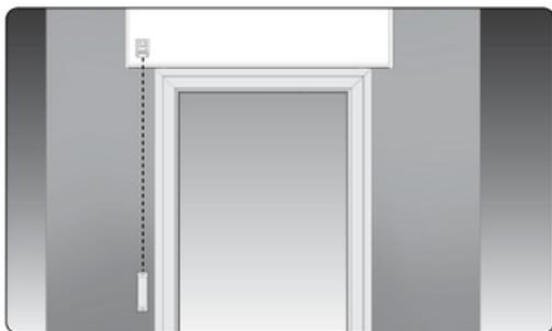
22. Das Gehäuse der Aufrollvorrichtung sollte auf der gleichen Höhe wie der Bandaustritt aus dem Rollladenkasten angebracht werden.
