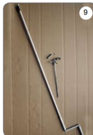
Kurbel, Kardangeln 45° oder 90° mit Pumpenträger [9].
